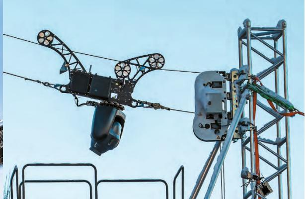
Die Highspeed-Seilkamera ist in fünf Achsen stabilisiert
